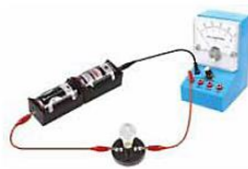
ภาพที่ 17 การทดลองการวัดกระแสไฟฟ้า
