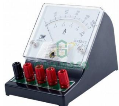
ภาพที่ 4 เครื่องมือวัดกระแสไฟฟ้า (แอมมิเตอร์)
