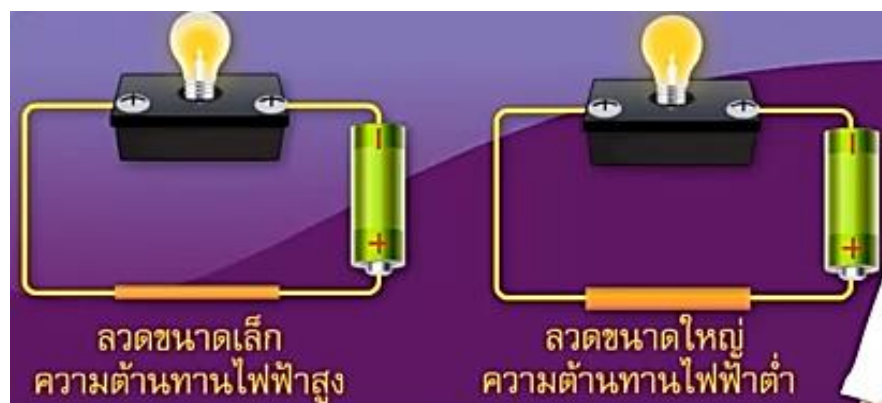
(ก) ภาพแสดงการเปรียบเทียบขนาดของลวดตัวนำที่มีขนาดเล็กและขนาดใหญ่
