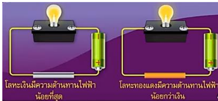
ภาพที่ 25 ภาพแสดงการเปรียบเทียบชนิดของลวดตัวนำ
