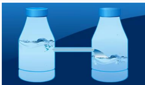
ภาพที่ 19 ความต่างศักย์ของไฟฟ้าระหว่างจุดสองจุดเปรียบได้กับการไหลของน้ำจากที่สูงลงสู่ที่ต่ำ
